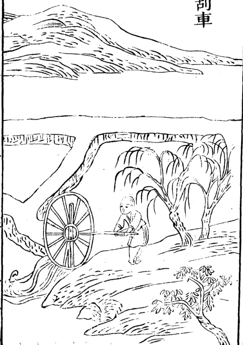
輻同濶然後立架安輪輪輻半在槽內其輪軸一端環以鐵鉤木拐一夫執而掉之車輪隨轉則衆輻循槽刮水上岸溉田便于車厚詩云創物須憑智巧先泝流能使
