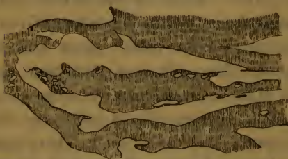
Fig. 24. Dichter Kalk, gekrüseitig mit tonigem Zetaschlamm verknetet. „Breccienbank“ inmitten der Zetaschichten des großen Zementbruches bei Schelklingen.
