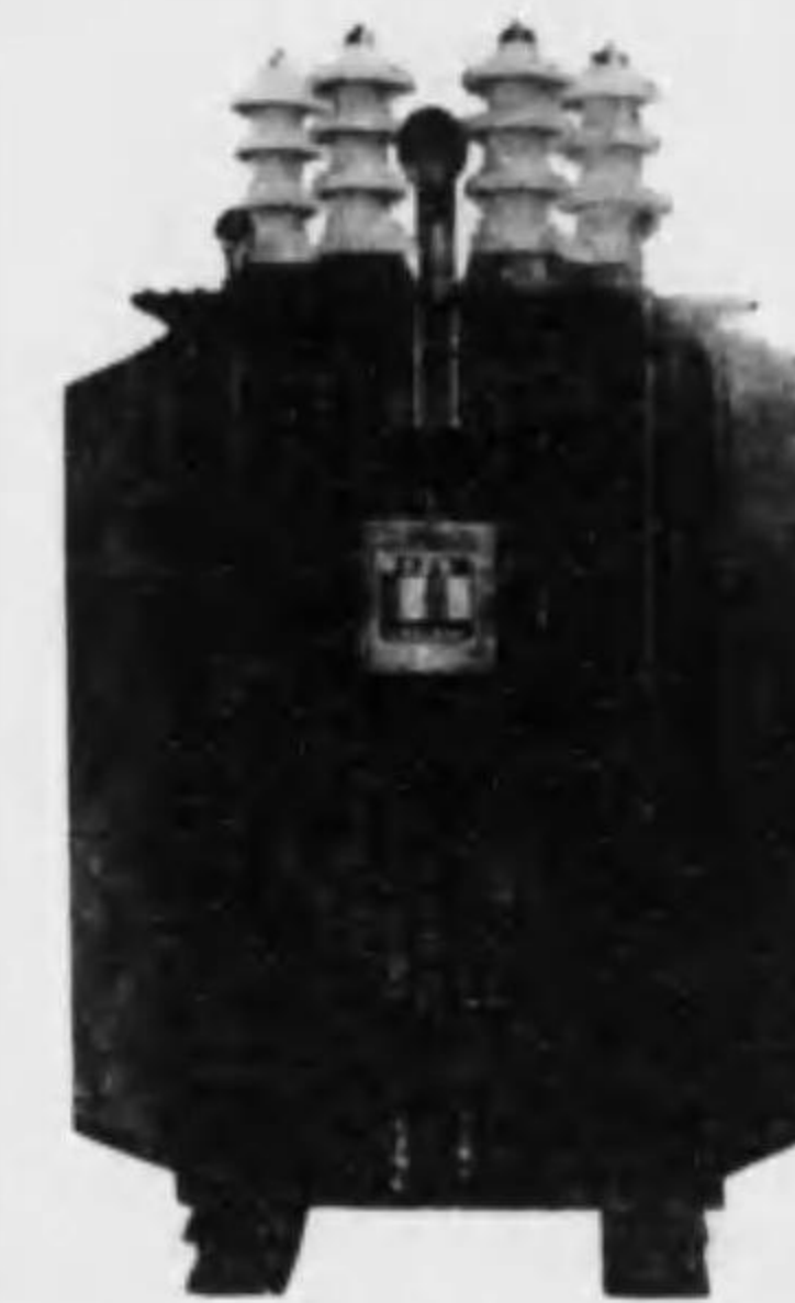
3,150ボルト 高内切換裝置付 で、二次側電壓は105/210ボ ルトである。
