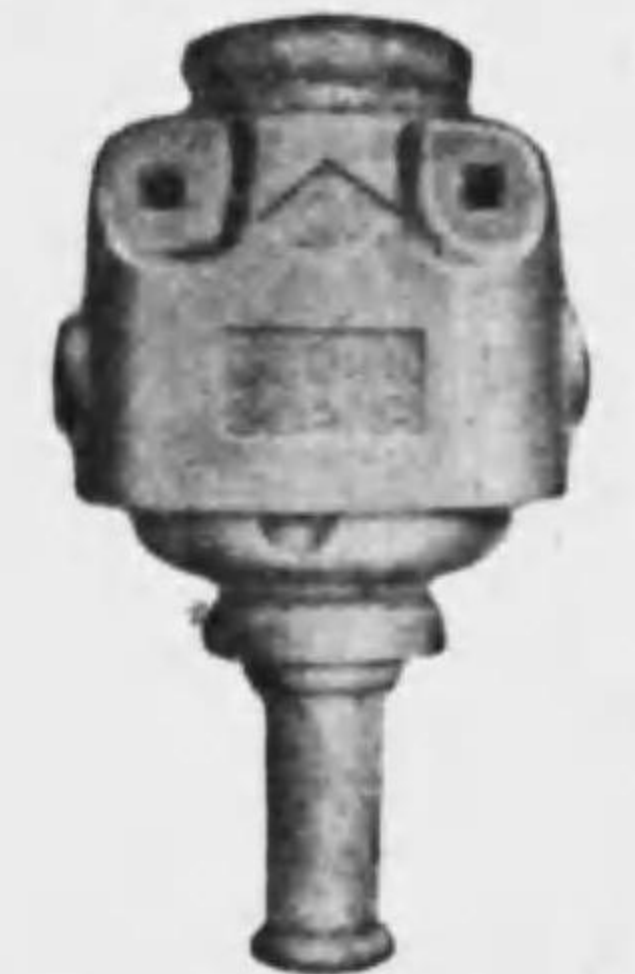
特許澤井式碍子型開閉器(電氣協會懸賞募集最高)位當選型碍子型開閉器 本器の構造は匣體部の絶縁壁にて可熔片熔斷の場合兩極間の火花短路を絶無ならしめ
