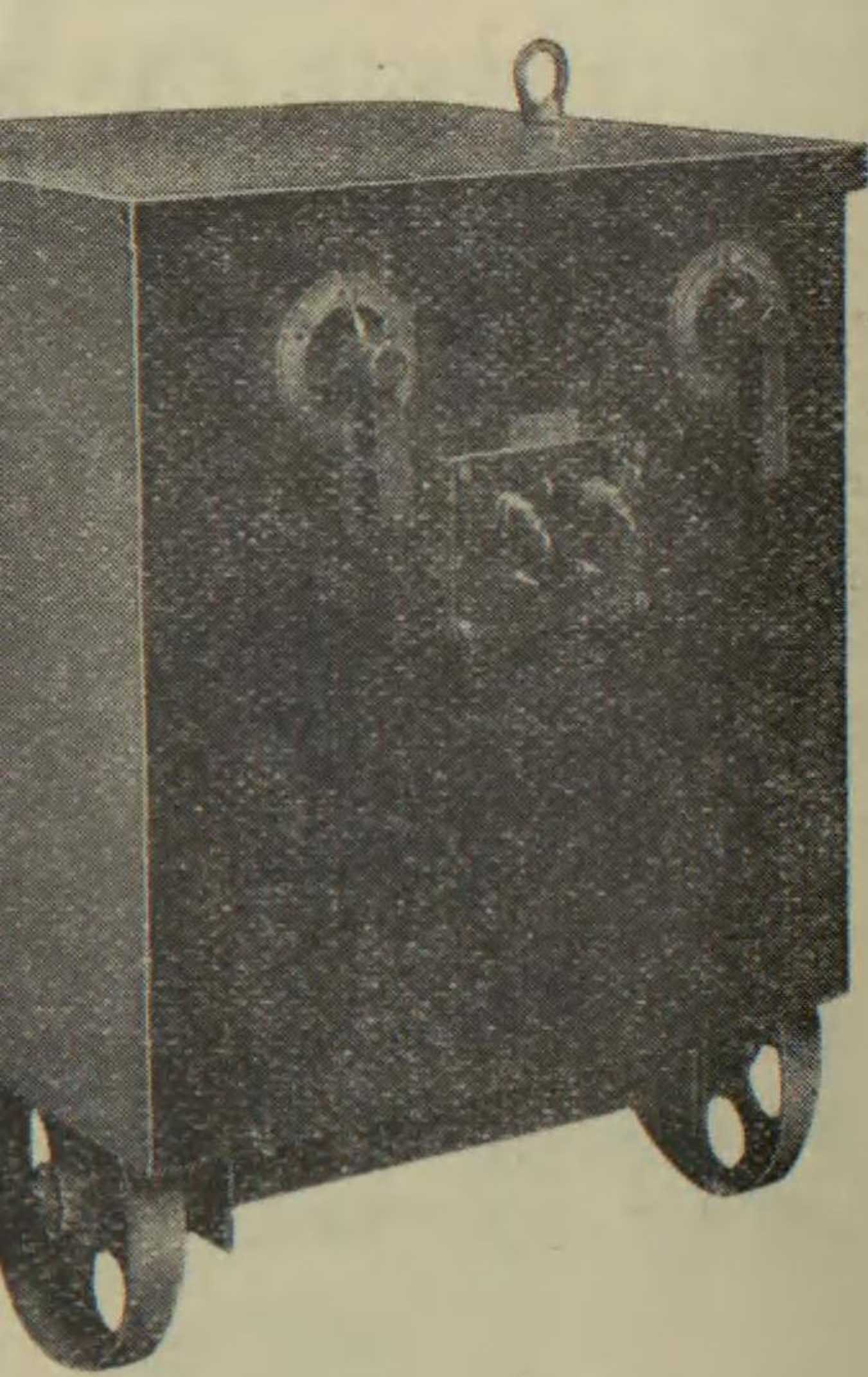
250A. フレックス アーク 溶接機
