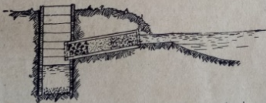
Rys. 30. Filtr dla studni przybrzeżnej.
