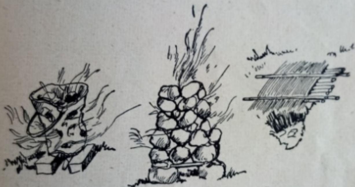
Rys. 20. Piece do spalania śmieci i pokrywa z gałązek do zbierania wypłuczyn.
