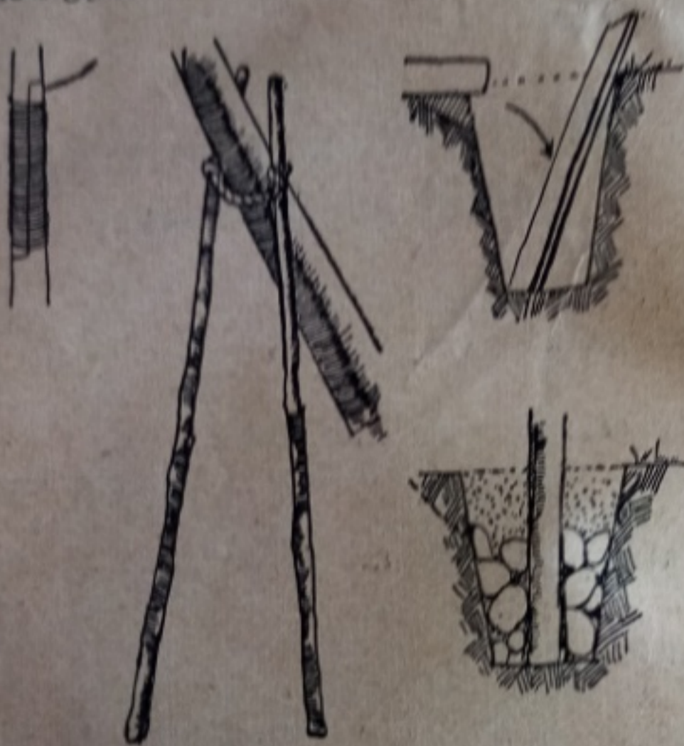
Rys. 1. Sztukowanie masztu, kozły, deska, po której zsuwa się odzimek, zasypany dół.
