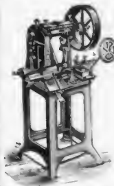
Máquinas para reforzar las esquinas de las cajas.
