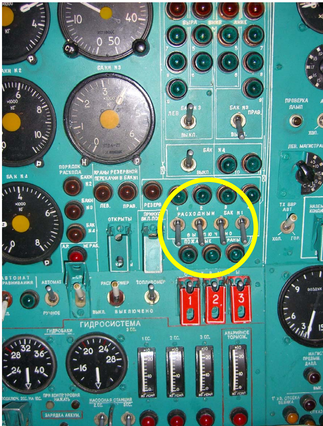
Рис. 25. Положение переключателей подкачивающих насосов на панели топливной системы самолета Ту-154М RA-85744 при осмотре кабины 04.12.2010 после авиационного происшествия
