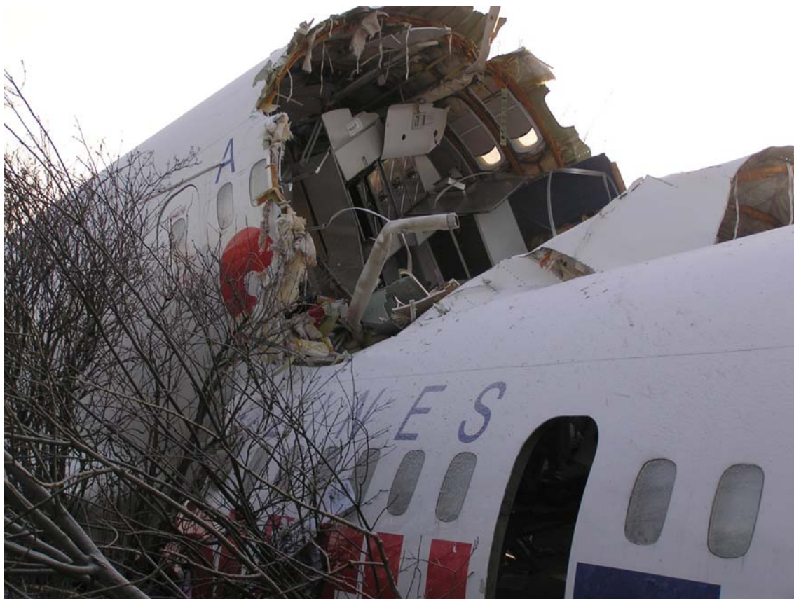
Рис. 2. Вид на разлом фюзеляжа в районе шпангоута № 32
