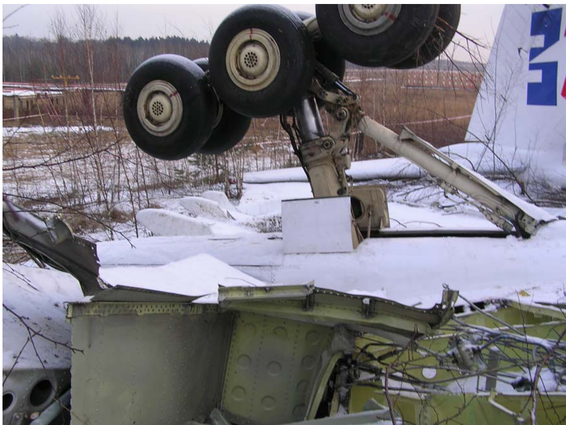
Рис. 13. Вид на зону разрушения заднего лонжерона крыла в районе нервюр №№ 4...6
