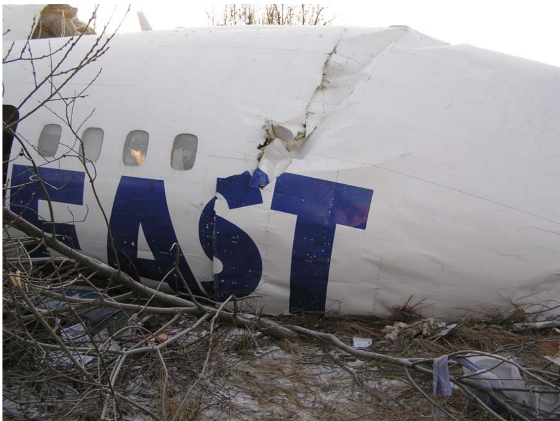
Рис. 3. Вид на излом фюзеляжа между шпангоутами № 14 и № 19
