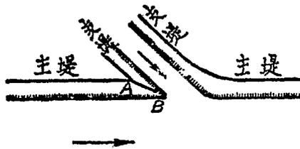
翼堤 (Flügeldeiche) 如第三七九圖，一端與主堤相接，堤頂與河岸同高，一端斜伸河中，乃所以防制河身之過分彎曲，勿使礙及主堤之安固者也。且洪水溢出河槽，平鋪下瀉，外灘之上，非僅淤積沙礫，亦常發生深溝與裂縫。翼堤之功用，亦足以分洪水之溢，使不為外灘害也。翼堤自 A 至 B
