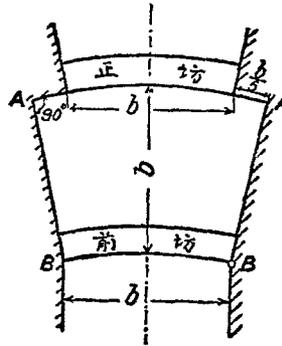
流槽，應力求堅定。槽底與兩坡，均須保護，其橫斷面參觀第二〇二圖及第二〇三圖。設荒溪區域之地質，已無變化，治導工程，又已實施，則荒溪區域以內，能極力植林，最為有益。
