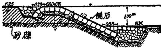
態依照梯形修圓，蓋尖角易為波浪及冰凌所衝擊也，第二五九圖之結構，乃日後改良之壩形，壩頂較前改低，而向岸一面，先用人工填土，因順壩之內，漲沙非易，預先填滿，可省去向岸一面之石工也，第二六〇圖之結構，亦一例也。
