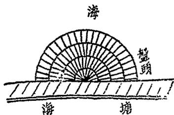
，高約三四丈，半徑約六七丈。柴性柔軟，耐於衝激，間有經蓋，隨時修築，參觀第三五八圖。亦有於塘外建築石壩以挑溜者，法以竹篾二層作底，內裝沙石，四周拋填塊石，以成坦坡之形。再安砌裝石木櫃二層，用塊石蓋頂。或不用竹篾木櫃，祇用塊石壘砌者，但易於滾失，不能耐久，參觀第三五九圖。
