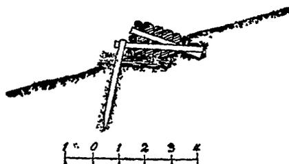
，故前坊之頂須高出正坊之基礎。二坊之距離，約為正坊高度之二倍至三倍。二坊之間，形如水池，其由正坊墜落之水流與沙石，以池水之抵抗，足以減輕衝擊之力，不易發生跌塘。惟二坊間之溪牀，仍須鋪砌大石塊。其兩旁邊牆坊用石砌。力求堅厚，基礎亦應深埋。據瑞士所建石坊之經驗，邊牆不坊略斜，結果甚善；堪以為法，參觀第一九九圖。荒須上部之溪牀，大都峻峭，則石則連接，形如坊梯，則牀並須全部砌石保護，但石面宜設，方可免減水勢，否則流速將更增大，冲刷為患，參觀第二〇〇圖甲乙丙及第二〇一
