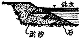
拋石，層層相疊，如第二二一圖。每級高度為2公尺，頂寬約為60公分。一級既成，即於其後，填積沙土，再造他級於其上，低水位以上，亦用鋪石護面。如遇水流猛烈之處，並須在鋪石之間，每隔10至20公尺之距離，加鋪較厚之石肋一道，寬約2公尺，則掩護工當更為堅實。拋石之脚，有袋釘木椿，以期穩固者，依據經驗，似非必需，因保護木椿本身，又須拋石於其外，方免椿下之洗刷也。
