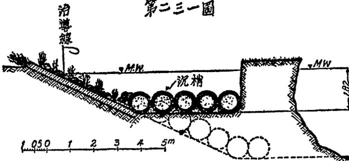
壘，可沿沿導線預挖深槽，做成坦坡，設置護岸工事，堆石槽中，待舊岸坍塌盡淨之時，則石塊下墜，適足掩護坦坡，石料缺乏之處，亦可代以沉槽。】(參觀第二三一圖)
