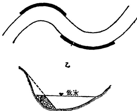
工，其結構須視就近取得之材料，及河岸之高度，地質之堅鬆，水面之高低，以及流力之強弱，冰漸之侵蝕而異。
