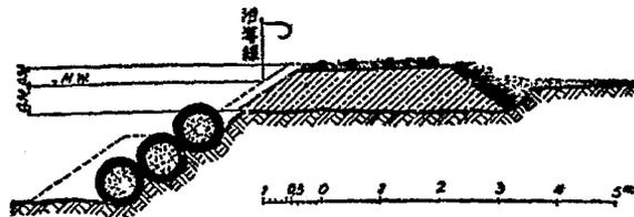
沙填平之後，再加填積，築成壩身，並鋪石護面，參觀第二五三圖。
