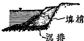
(三)填梢工 (Packwerk) 以填梢護岸之法，參觀第二二三圖及第二二四圖。如填梢工非直接靠岸，其構造如第二二五圖。填梢工之下為沉排 (Sinkstuck)，前為拋石，後為填沙，蓋於岸之前，河牀不平，填梢之下，宜先布沉排，最
