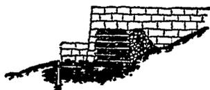
坊脚前面，堆石掩護，如第一九一圖。但跌水功效甚小，時日既久，仍屬難免損壞。是以欲求石坊之基礎穩固，最好在正坊(HauPtsPerre)之前，加築前坊(VorsPerri)，參觀第一九二及一九八圖。前坊之功用，為掩護正坊之基礎
