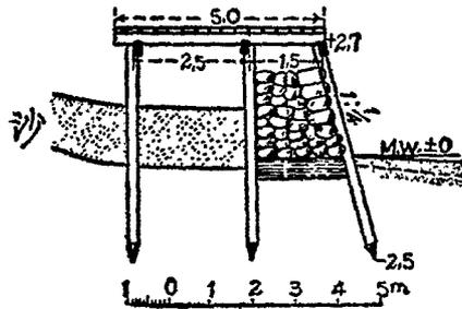
護岸工有作岸壁式者 (Ufermauer) 亦建於舊岸之前，其間距離，視岸壁上所需之坡度為準。壁前之基礎，宜求堅實，導洩壁後積水，亦應注意，參觀第三四一圖至第三四二圖。
