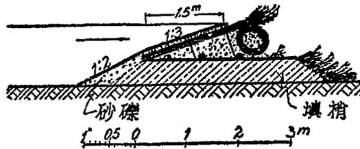
在此項攔沙工之間，並安設梢把 (Faschinenbündel) 插入岸內，亦足以輔助，參沙中觀第二六八圖。設在柳枝出產豐富之區，攔沙工可用短而薄之沉梢爲之。例如第二六九圖，爲多惱河淤沙工攔之結構，沉梢之構造，係選用長枝，中包碎石，手工紮縛而成。鋪至水面高度，編纏一道，再用石塊護面。其迎水一面，並密排斜梢一行。斜梢之前，用小沉艋兩個或三個掩護攔沙工之基址。但此項建築，宜在水流
