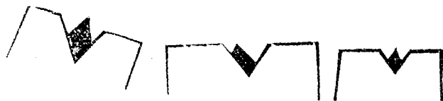
d. 照門傾向右方 e. 準星偏左 f. 準星偏右
