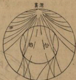
第19圖 地震時震波在地內傳播情形
