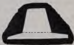
Fig. 9. Spåren i tornmuren för bärbjälkar till en yttre skyttegång.
