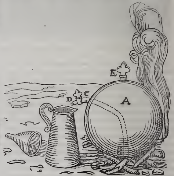
Fig. 1. Appareil d'expérience de Salomon de Caus. (Fac-simile.)
