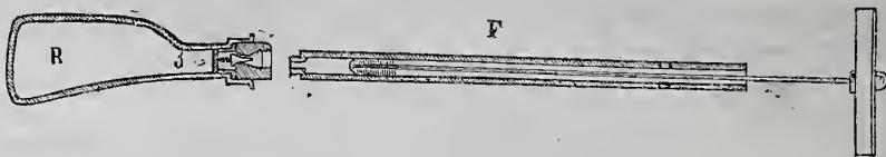
Fig. 3. Coupe longitudinale du réservoir et de la pompe foulante destinée à charger le fusil.
