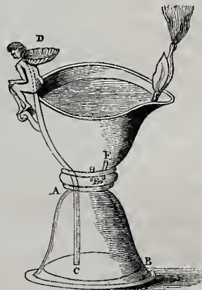
Fig. 5. Lampe hydrostatique de Héron.
