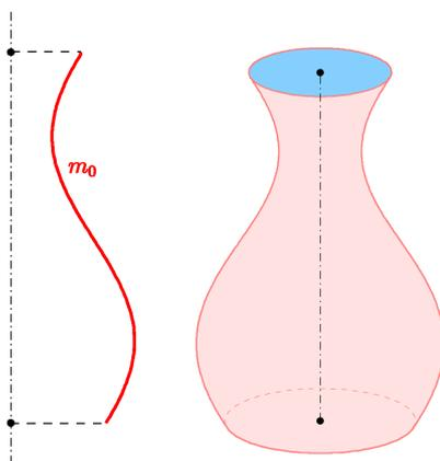
Wenn man die rote Kurve um die  $y$ -Achse rotieren lässt, entsteht die Vasenoberfläche. Wenn die Kurve algebraisch ist, so ist auch die Fläche algebraisch.
