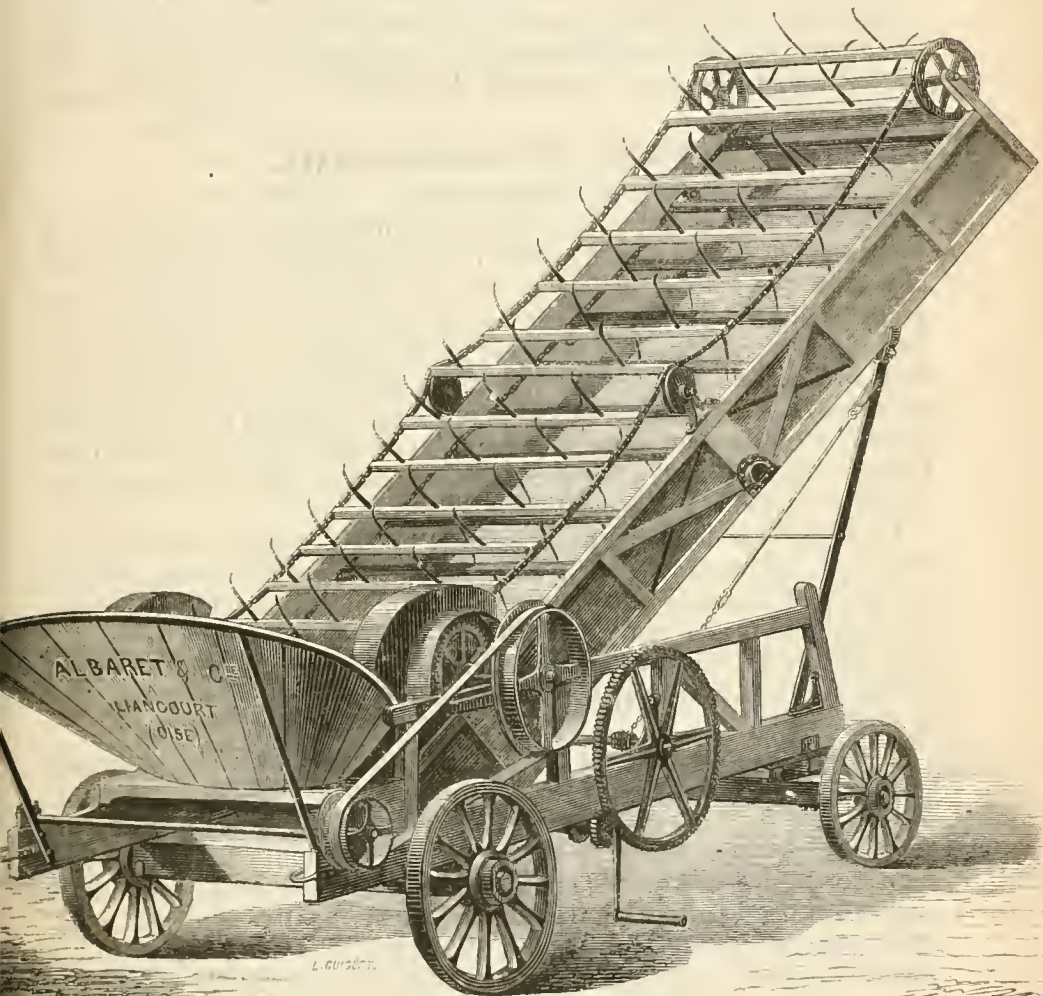
Fig. 10. — Élévateur de paille système Marshall, construit par M. Albaret.
