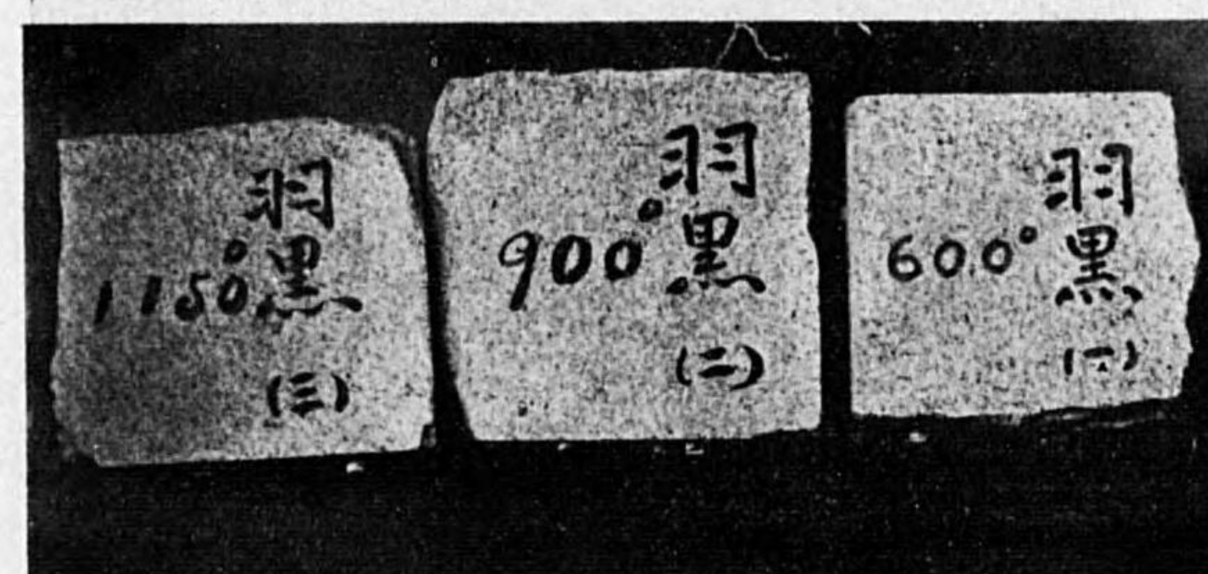
加熱後 (寫真ニテハ明瞭ナラザルモ加熱ノタメ組織 ユルミタルモノナリ)
