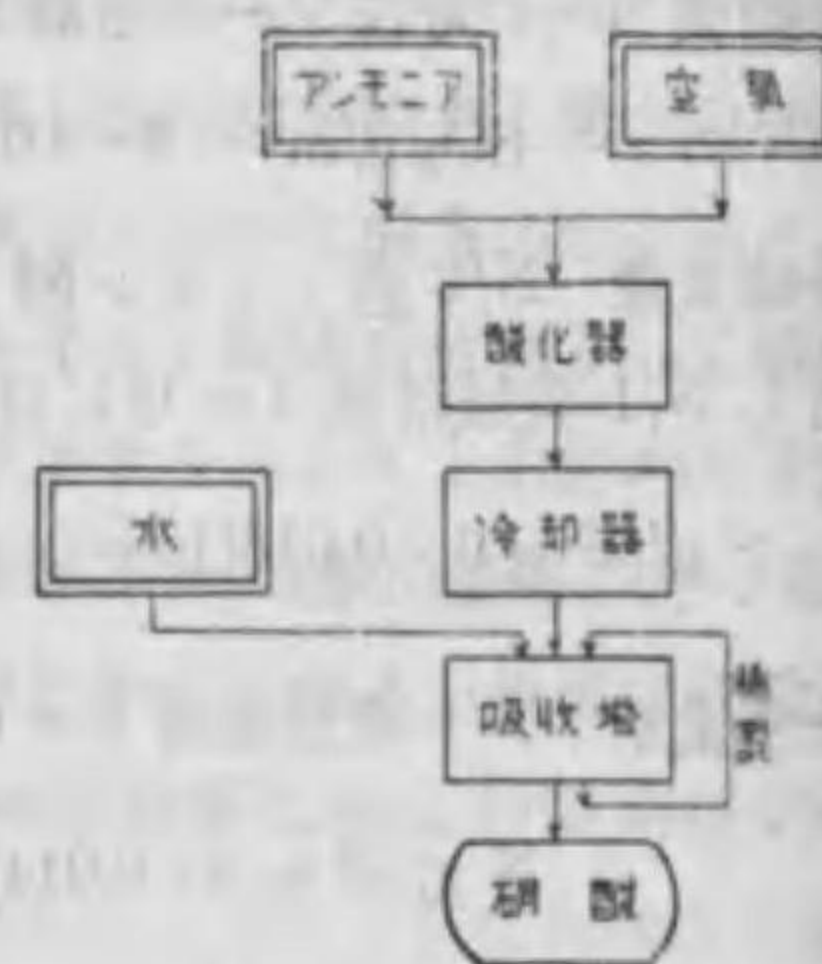
合成硝酸製造工程圖
