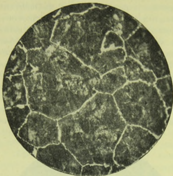
Сним. № 2. Ув. = 150 d. Рельсъ 79 (серед. головки); вытравл. пикриновой кислотой.
