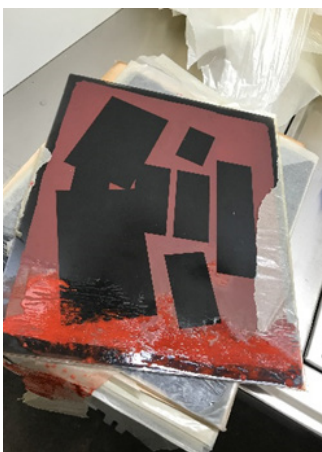
Tätpackade plåtlådor som klipptes upp på grund av att kuverten svällt, repronegativ med upplöst maskeringsfärg och sanering av glasplåtar. De cirka 100 000 negativen fyllde en pall med 9 pallkragnar. Foto: Sara Ellenius.
