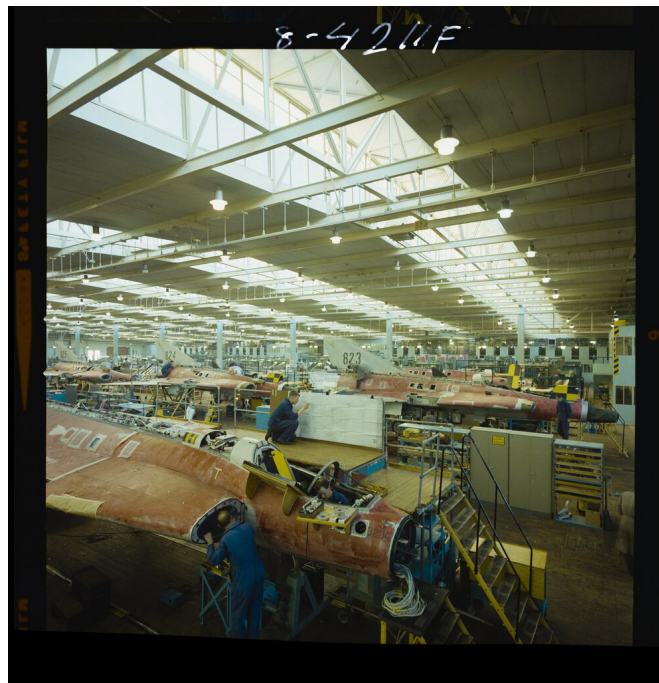
Ett av foton som fick uppdaterad metadata och beskrivning under arrangemanget. Bilden föreställer sammanbyggnadsarbete av Saab 35 Draken i hall 2, i Saab-fabriken i Linköping. Flygplanet har en väv på sig med röd plastfärg på, som skydd under arbetet när arbetarna går på dem. Siffran på fenan beskriver individnumret för varje flygplan. Nummer 824 och 825 slutgodkändes 2 maj 1963, så fotot är taget tidigare samma år.
