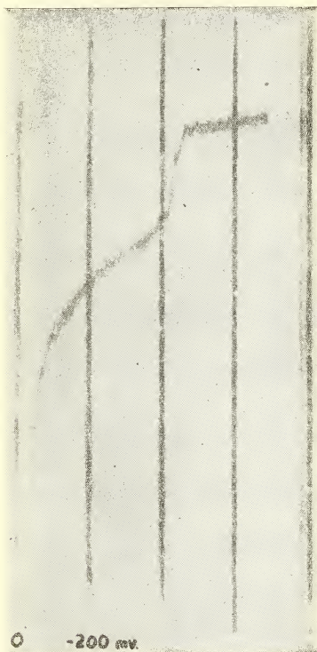
FIG.2. — Obrera de la industria del plomo. Polarograma obtenido con dos electrodos. Se observa un evidente salto de plomo, que, aplicando el método de adición, corresponde a 150 gamas por 100 cm 3 de sangre. Sensibilidad 2.
