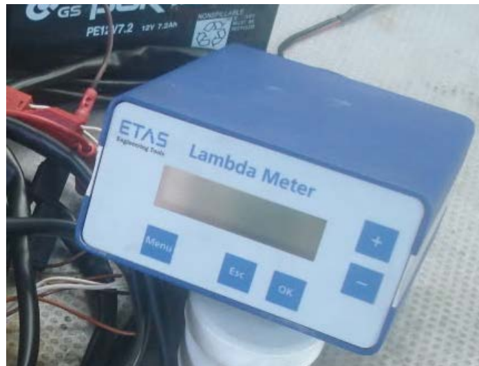
Figure 59. ETAS LA4-4.9 Lambda Meter
