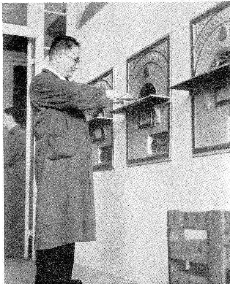
化驗小用煤氣爐化驗成色
