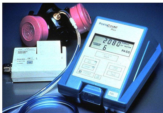
Прилад для кількісної перевірки ізолюючих властивостей PortaCount, вгорі - напівмаска з зондом для відбору проб повітря
