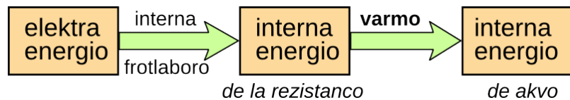
Fig. 7.17: Mergoboligilo kaj ĝia energitransformĉeno
