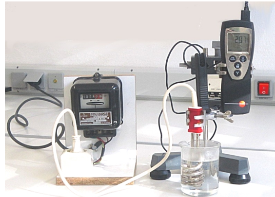
Fig. 7.18: Mezuro de elektra energio kaj temperaturo
