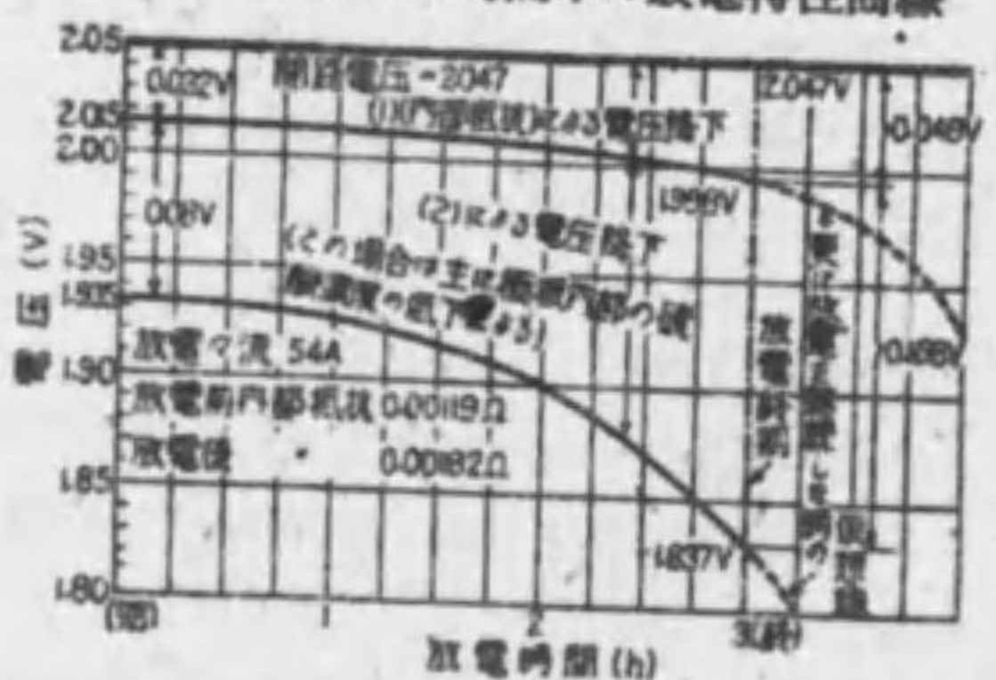
第 13 圖 放電中の電圧降下の分解
