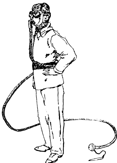
第二十九圖 Degea 廠新鮮空氣自吸器
