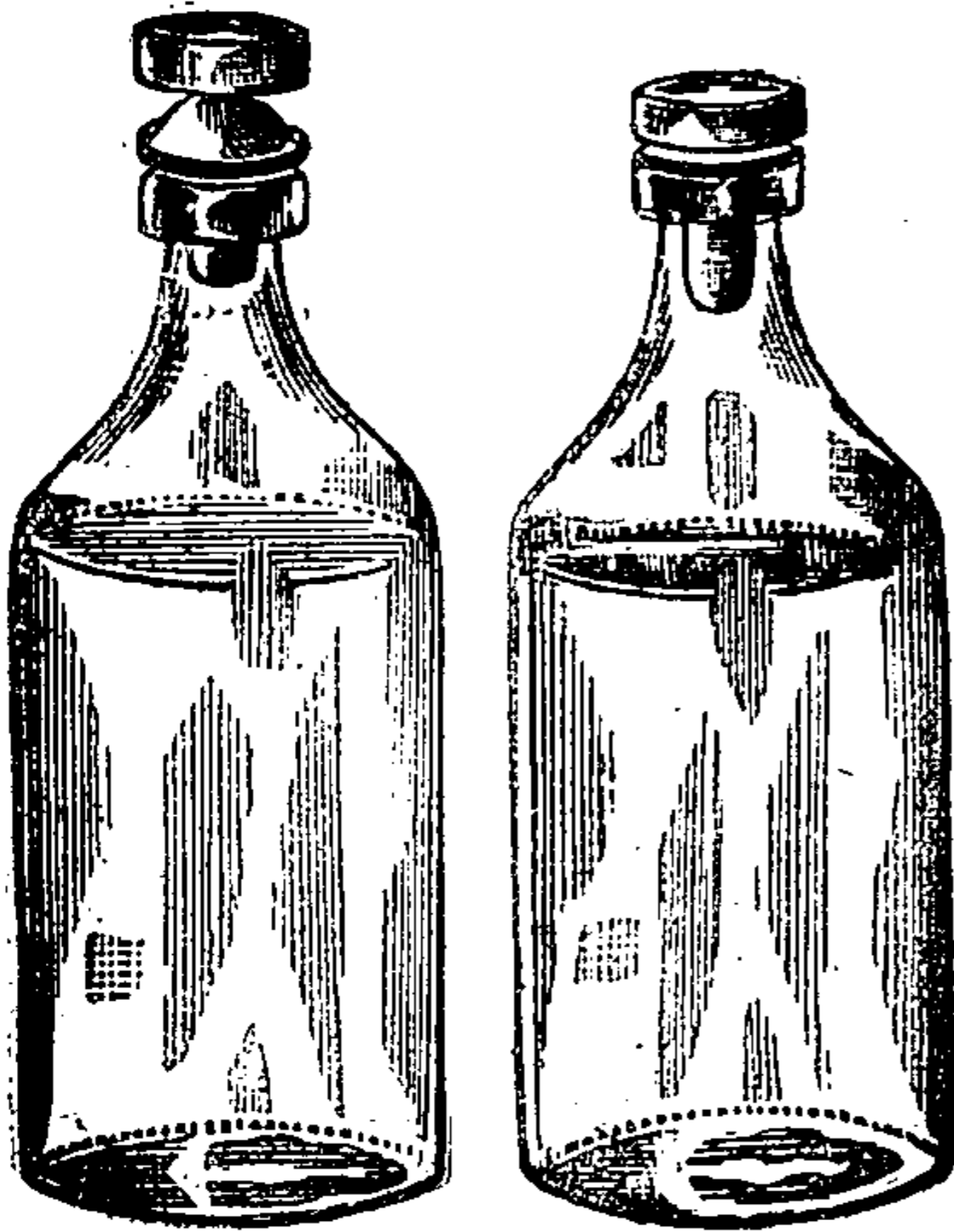
Fig. 30 et 31. — Bouchon pneumatique de porcelaine avant et après la stérilisation.
