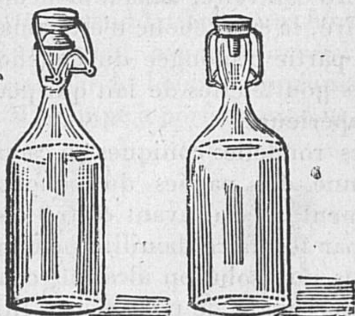
Fig. 32 et 33. — Bouchon pneumatique mécanique.
