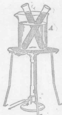
圖 64. 將試管浸於熱水中，使其中的液體加熱
