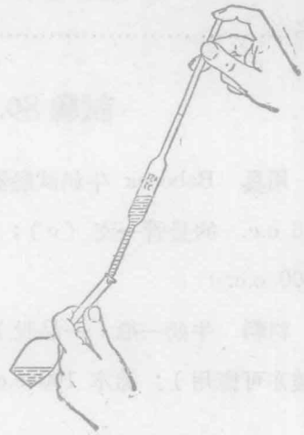
圖 67. 測定牛奶中的脂肪量時，將牛奶加入試瓶中法。
