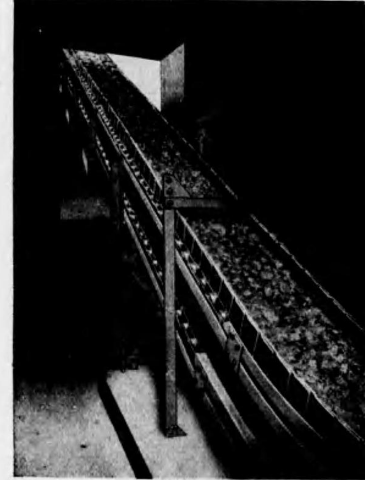
原料をクラツシヤより貯藏場へ輸送 するエプロン・コンベヤ
