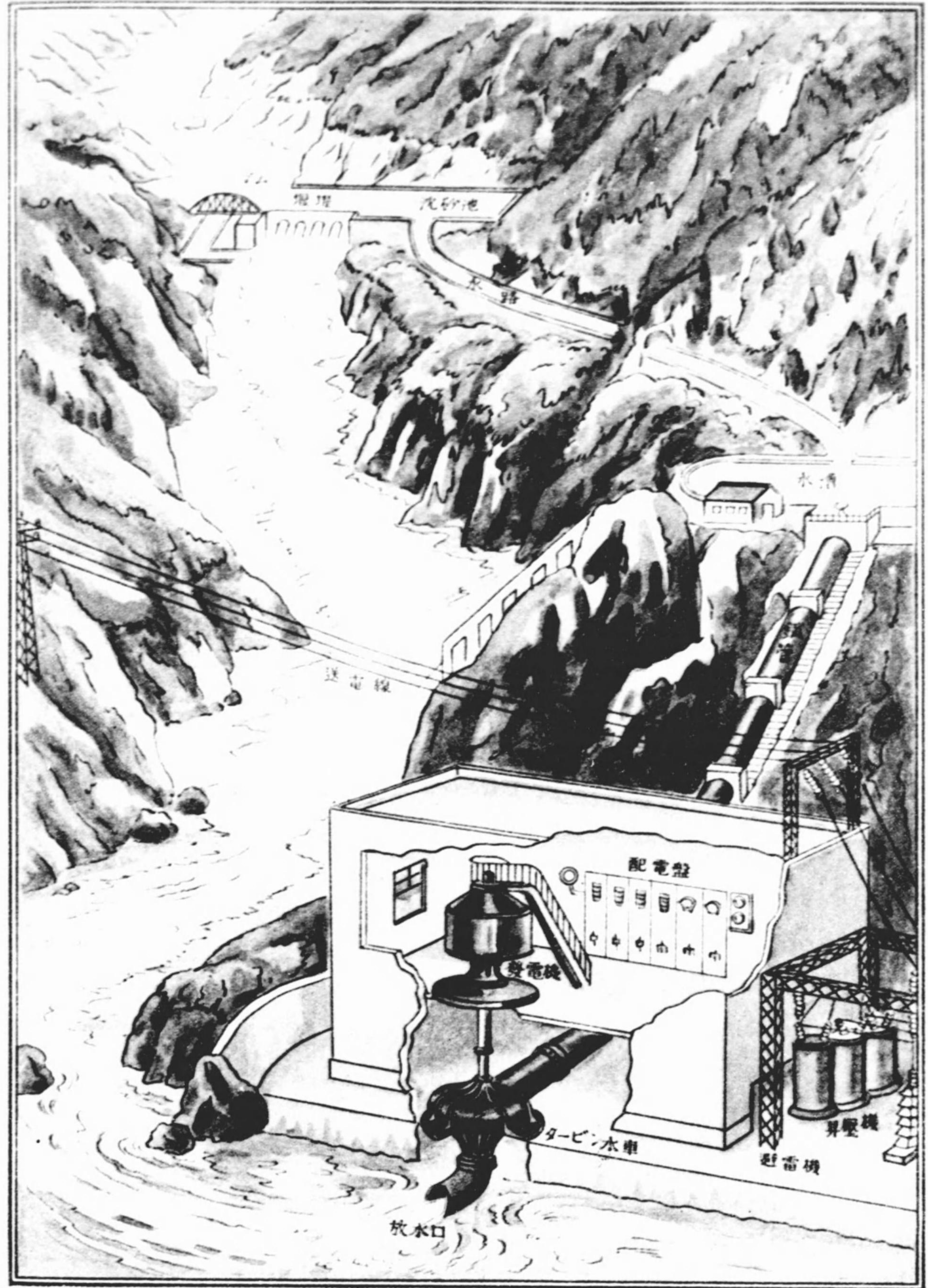
水力発電所の全貌
