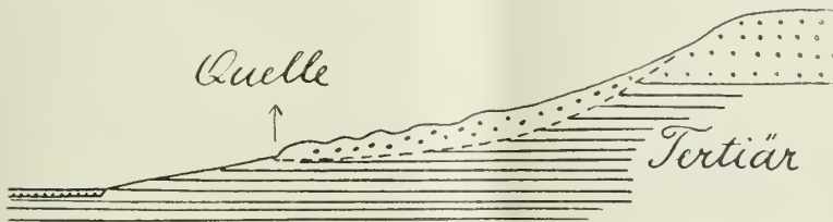
Die Grenze zwischen dem Tertiär und Quartär (Sand) am Gehänge und im Hügel selbst.
