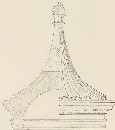
Abb. 70. Der Deckstein eines Brunnenhauses.
