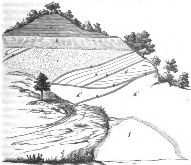
a. Mergeliger Kalk. — b. Braunlicher Sand mit Geschieben an der Gränze. — c. Thoniger Sand. — d. Grauer Sand in Lagen. — d'. Grauer Sand ohne Schichtung. — e. Eisenschüssige Sandbänder. — f. Sandgrube.
