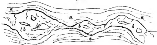
a. Hangendkalkstein. — b. Erzlagermasse. — c. Liegendenschiefer.
