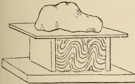
Fig. 3. Esperimento di Hall per spiegare la contorsione.
