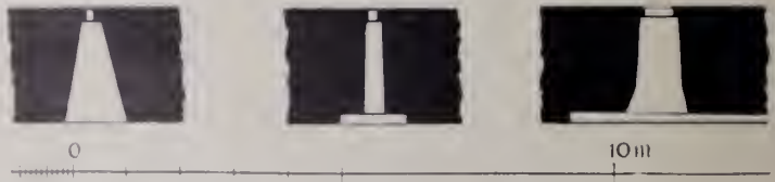
Fig. 596. Zschorna, Schloß, Kellergeschoß, schießchartenartige Fenster
