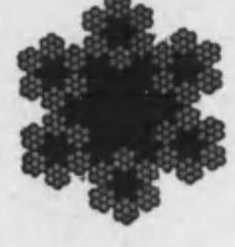
ケーブルレドロープ 7本線6撚鋼索6本撚 中心及各子繩共麻入
