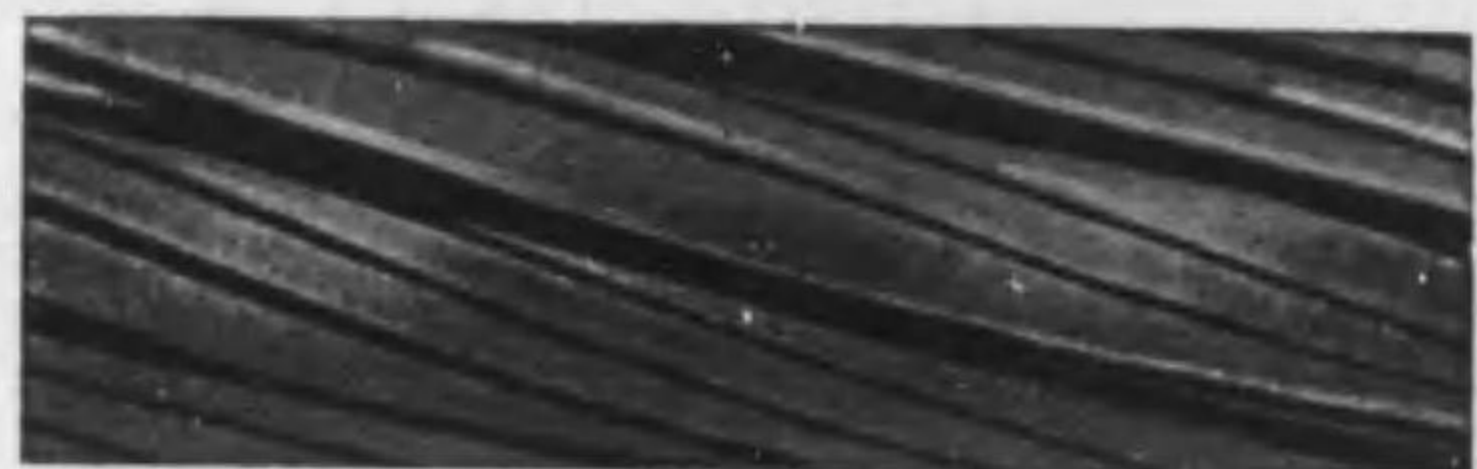
同上 摩損状態
