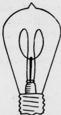
電流，使達相當熱度。炭化氫受熱分解，炭粉黏附於炭絲之上。其黏附速度，視諸溫度高低，故瘦小部份，阻力較大，熱度較高，而黏附炭粉亦較速，結果面積不劃一之弊可略為改正。至全絲阻力，達於預定之點而後止。第二圖為炭絲燈之形狀。
