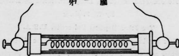
電燈最初之製造，在民國紀元前九十一年，其時狄拉路 (De la Rue) 用鉛絲一卷，置諸封閉之玻璃管中，因鉛絲熔點之高，實驗竟呈成效。但實際上，因鉛價昂貴，用途不能擴張，其手製燈泡形狀，可見第一圖。
