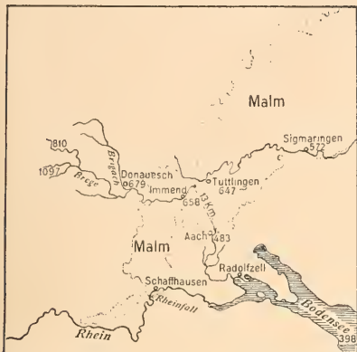
Abb. 1a. Die Donauversickerung zwischen Immendingen und Tuttingen. Die punktierte Grenze umschließt das Kalkgebiet des weißen Jura.
