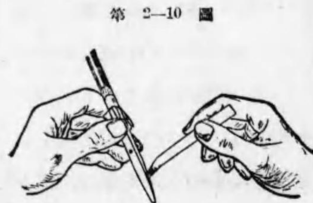
第 2-10 圖 烏口に墨を含ませる所 烏口に墨液を含ませるには、細長く切つた少し厚い紙のさきで、墨液を掬ひ取り、二枚の
