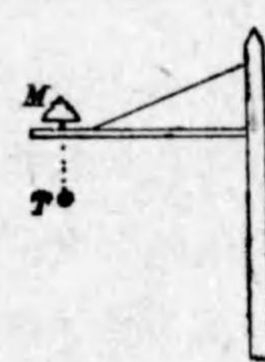
第 105 圖 腕金式支持法 (鏈線吊架法)
