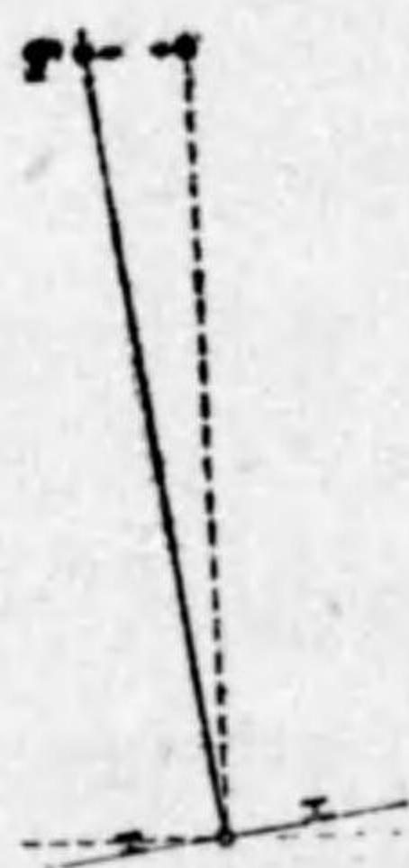
第93圖 曲線軌道に於ける電車線位置
