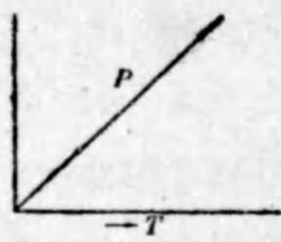
第 11 圖 牽引力に對する出力の關係 (直流分捲電動機)
