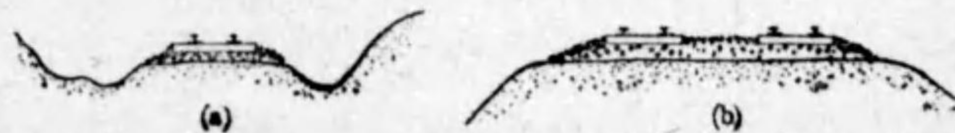
第 67 圖 専用道路上の軌道
