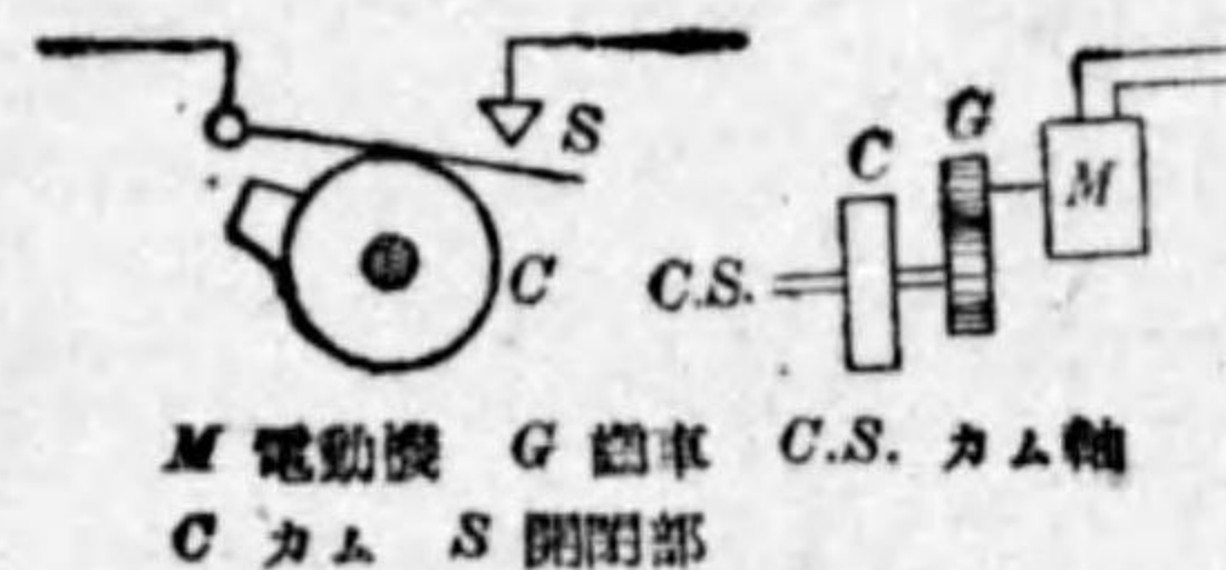
第 26 圖 電動機カム軸式總括制御
