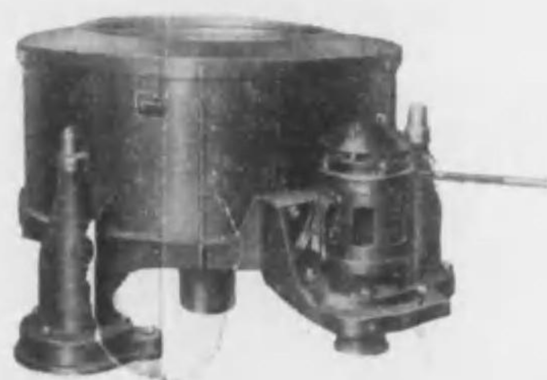
懸垂型遠心脱水機 フリクションクラッチ付
