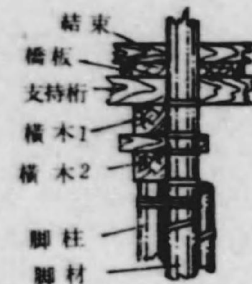
脚材ヲ沈下スル際ニ横木(冠材)ノ位置ヲ調整スル法 高+? 側面圖
