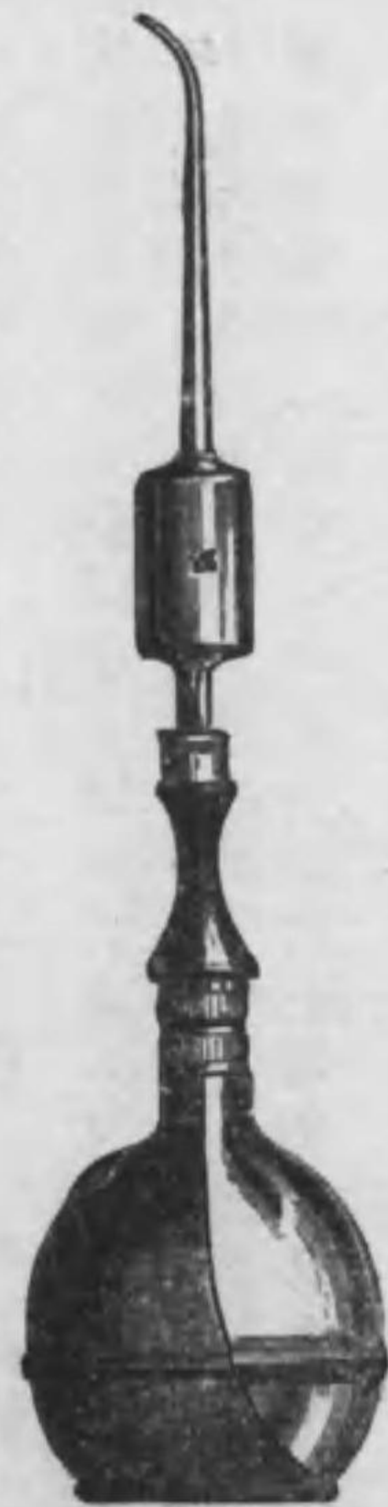
第九圖 b、或ハ熱氣乾燥器 Hot air syringe ヲ用ユ (第二十九圖)器ハ前者ト同一ナレトモ只一側ニ於テ内方ニ開キ
