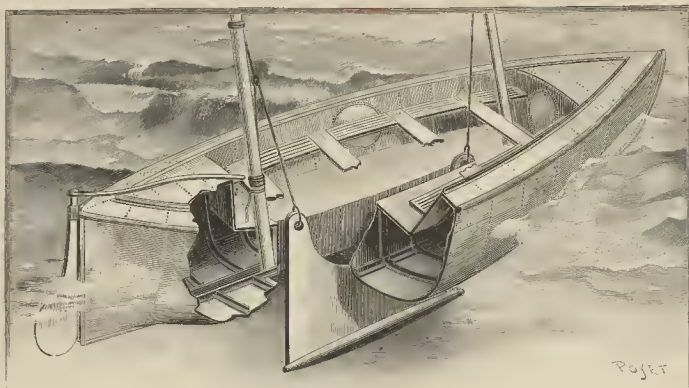
LA LANCHA INSUBMERSIBLE HENRY. - 1. Vista interior de la lancha. - 2. Sección transversal de la lancha
