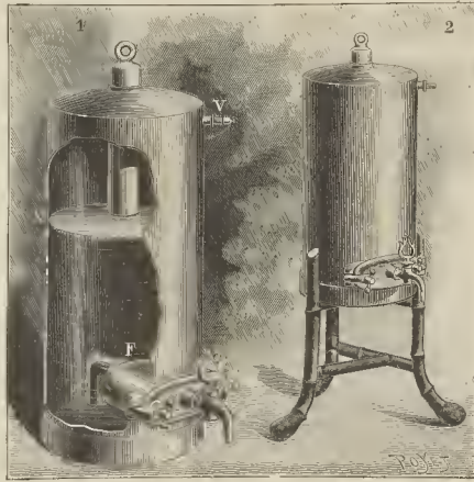
FILTRO PORTÁTIL DE PRESIÓN. - 1 Sección interior. - 2 Vista de conjunto
