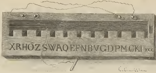
Fig. 5 - Regla eléctrica transmisora
