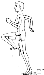
图19 人体的主要关节中心示意图
