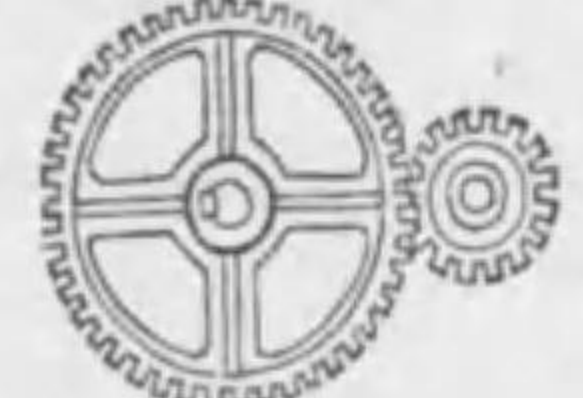
車輪ノ周圍ニ齒アリ此車ヨリ被車ニ動力ヲ通ス
