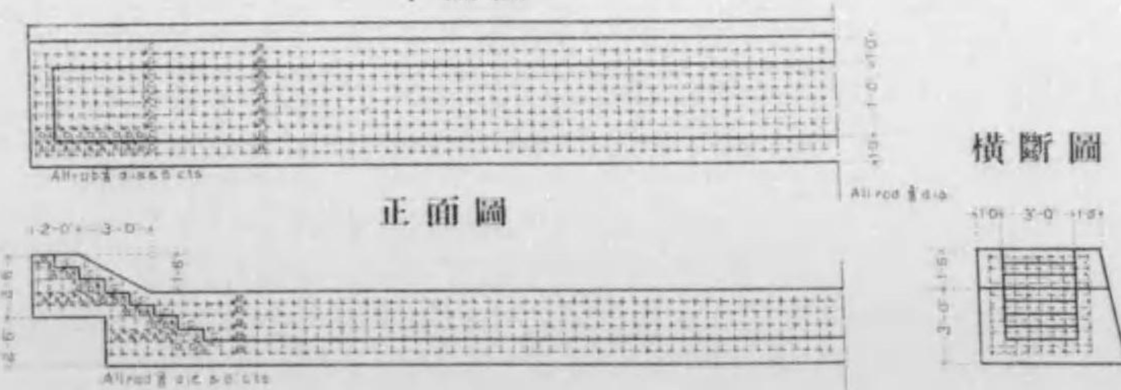
舟車道鐵筋配置圖 縮尺百五分之壹
