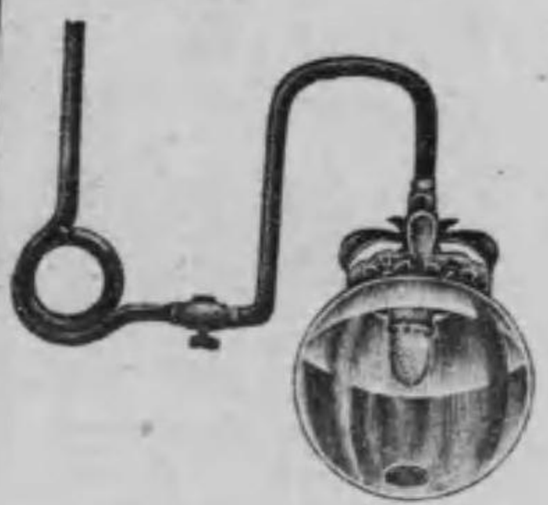
第五五圖 アウエル 燈 マン ト ル は 石 炭 瓦 斯 を 燃 焼 せ し む る 装 置 に し て 底 部 に 近 き 環 を 廻 し て 通 氣 孔 の 大 き を 加 減 し 燃 焼 の 温 度 を 任 意 に 調 節 す る こ と を 得 、 十 分 盛 に 燃 ゆ る と き の 焰 の 温 度 は 一 七 〇 〇 度 以 上 に も 達 す る こ と を 得
