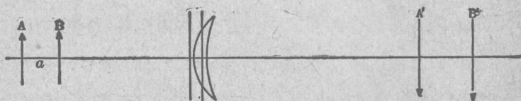
第 109 圖 凸透鏡之焦距檢定法之原理
