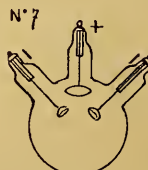
Fig. 89. — Ampoule bicathodique Seguy à anode rapprochée.
