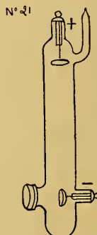
Fig. 103. — Ampoule à anticathode interchangeable (Seguy).
