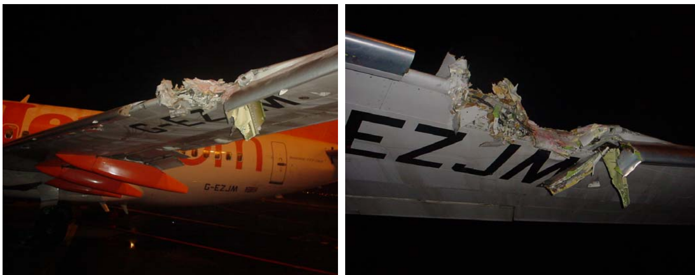
Figuur 3: foto's van de schade aan de linkervleugel
