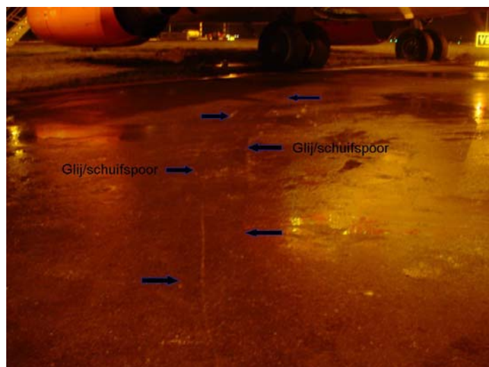
Figuur 5: Foto's van het vliegtuig na het ongeval en de sporen op het platform
